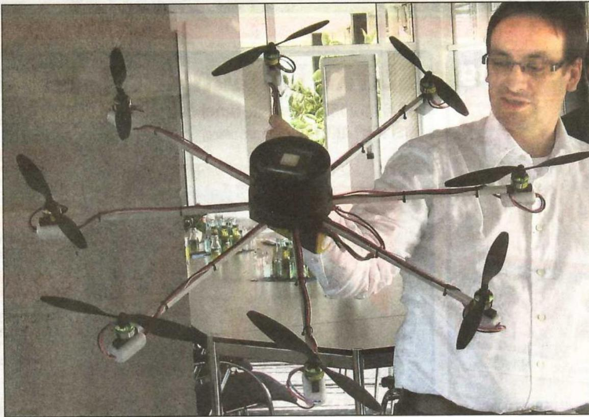
**Der Prototyp des Microcopters:** Oben hat Daniel Lorenz den Chip für die Steuerung per Navigationssystem angebracht. „Geflogen“ wird der Helikopter vom Boden aus. Foto: Lioba Knipping
