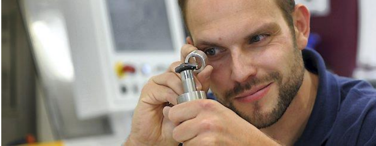
In der Produktion: Feinoptiker Benny Richter prüft die Oberfläche einer asphärischen Linse. Foto: Tino Zippel
