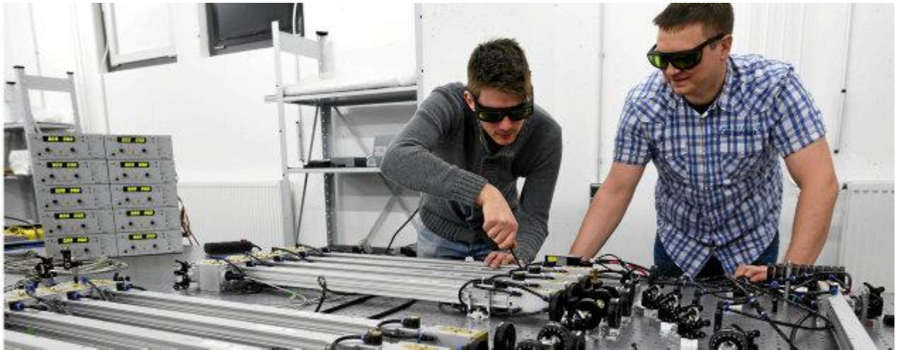
Armin Hoffmann (links) und Entwicklungsleiter Tino Eidam arbeiten bei der Active Fiber Systems GmbH an einem achtkanaligen Laser. Foto: Tino Zippel
